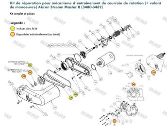
**Optimisez la performance et la durabilité de votre canon AKRON Stream Master II 3480-3482** avec cet ensemble d'engrenages spécialement conçu pour le mécanisme d'entraînement avec courroie. Adapté aux modèles équipés de l'option **volant de manœuvre**, cet ensemble garantit un mouvement fluide et une précision accrue lors de l'orientation du canon.
