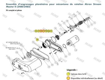
Optimisez la rotation et la précision de votre canon incendie Stream Master II (3480-3482) grâce à cet ensemble d'engrenages de remplacement. Conçu pour garantir un fonctionnement fluide et une transmission de puissance efficace, ce kit permet de restaurer les performances d'origine du mécanisme de rotation.
